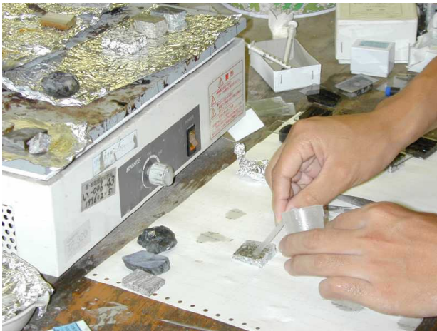
研磨した面をエポキシ系接着剤でスライドガラスに張り付けます。
