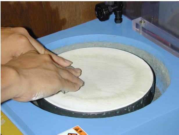
試料表面が鏡のように輝くまでダイヤモンド微粉末（0.5μm以下）で研磨します。
