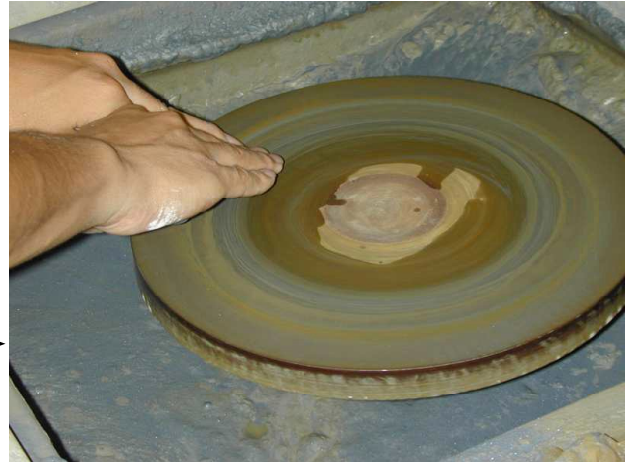
回転研磨盤上で粗い研磨剤で削って平面を出します。次に、鉄板やガラス板上で、だんだんと細かい研磨材で擦って平らな接着面を作ります。
