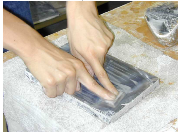
試料をスライドガラスと平行に切った後、回転研磨盤で削って、0.5mm程度の厚さにします。その後、#400、#1000、#3000の研磨材で手擦りして、厚さ0.023～0.025mmまで薄くします。
