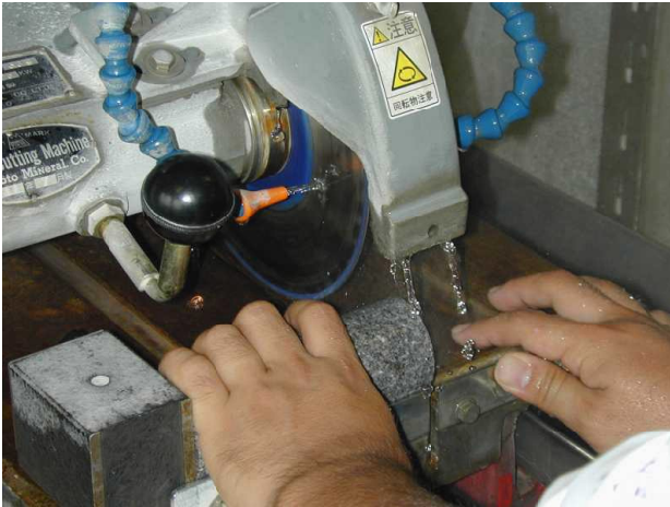
岩石をダイヤモンドソウで切断し、25×35mm程度で厚さが約8mmのチップを作ります。
