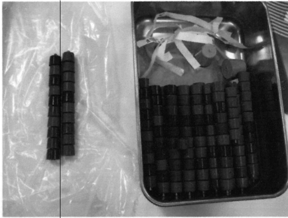
写真2 高電圧整流回路に使われるダイオードおよび抵抗器。それぞれ230個、2個を交換
