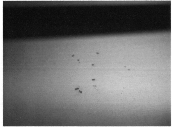
写真3 高電圧スパークの痕跡
