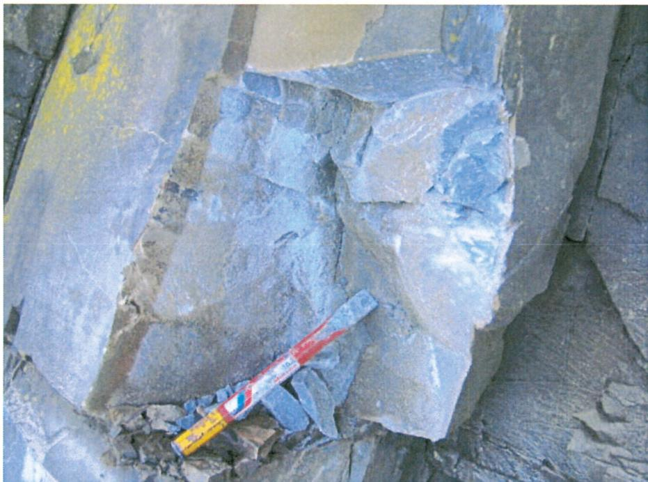
図 3 : 分析に供した石灰質砂岩試料 06100303 の採取跡。左方に風化断面が観察される。タガネの全長は 18cm。
