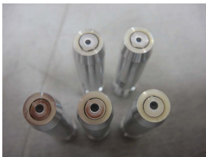
写真 2 上段：1.5mm 径孔のターゲット 下段：2.0mm 径孔のターゲット
