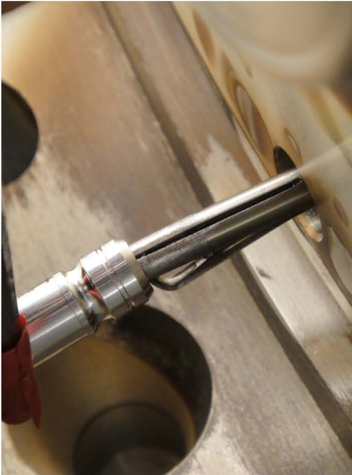
写真 1 ターゲットを掴んで固定する爪が破損して折れ曲がった。 このため、ターゲットをきちんと掴むことができなくなった。
