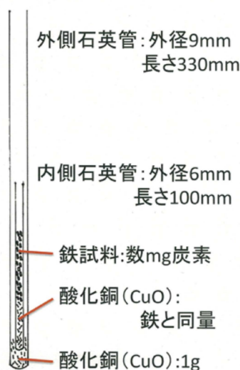
図 1 金属鉄, 酸化銅と 6mm 及び 9mm 外径の石英管のセットアップ図
