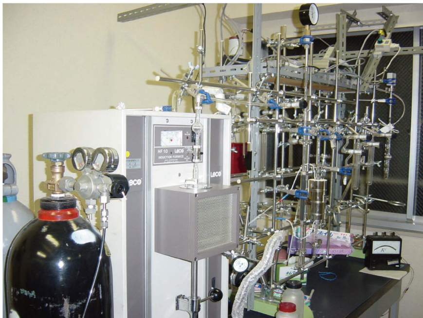
写真1 高周波加熱炉と \text{CO}_2 回収用の真空ライン
