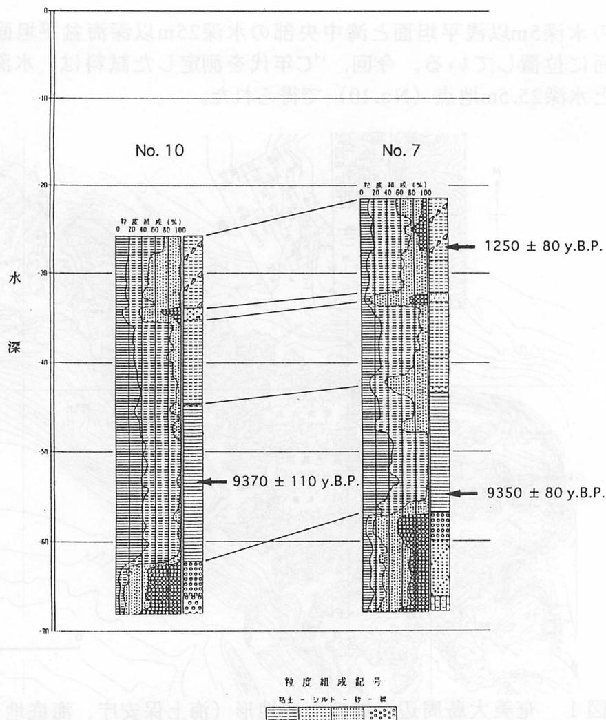
図2 海底ボーリングコアの対比と<sup>14</sup>C年代測定層準
