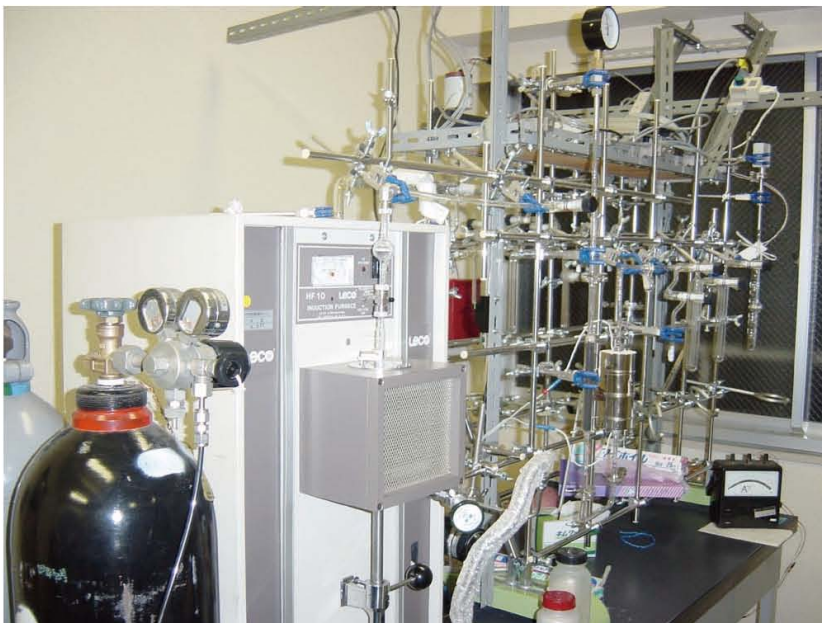
写真1 RF加熱炉と \text{CO}_2 精製抽出用の真空ライン
