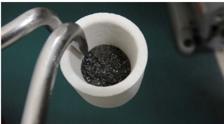
写真2 燃焼試料の入った坩堝。プラント・オパール：300～500mg，鉄助燃剤：1500mg ( \text{C} < 8 \text{ ppm} , \text{CO}_2 < 0.012 \text{ mgC} )，酸化銅粉末：～500mg，るつぼ容量：～4mL
