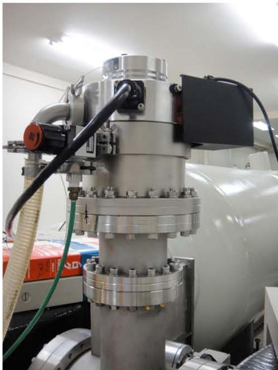
写真3 リンコンビネーター部に組み込まれているターボ分子真空ポンプ
