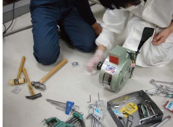
写真5 加速器タンク内の発電機の交換
