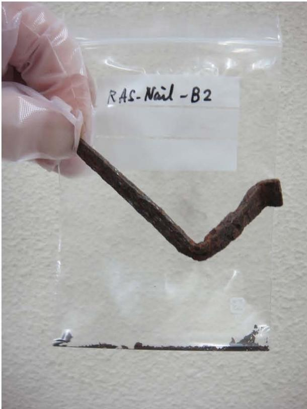
写真5 サビた鉄釘試料 RAS-Nail-B2
