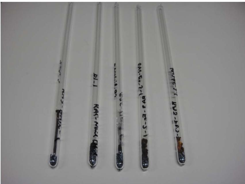
写真6 石英管に鉄サビ試料を酸化銅と共に真空封管
