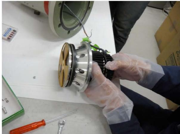
写真4 GVM 装置のモーター部分の取り外し交換
