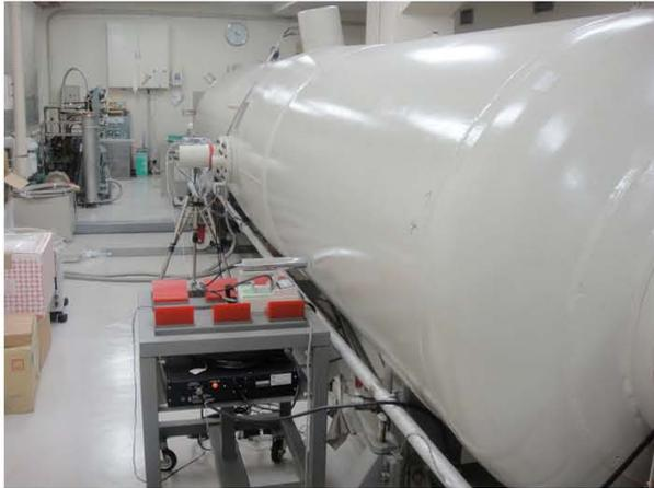
写真1 加速器タンクの中央後ろ側にヘソのように飛び出している GVM 装置
