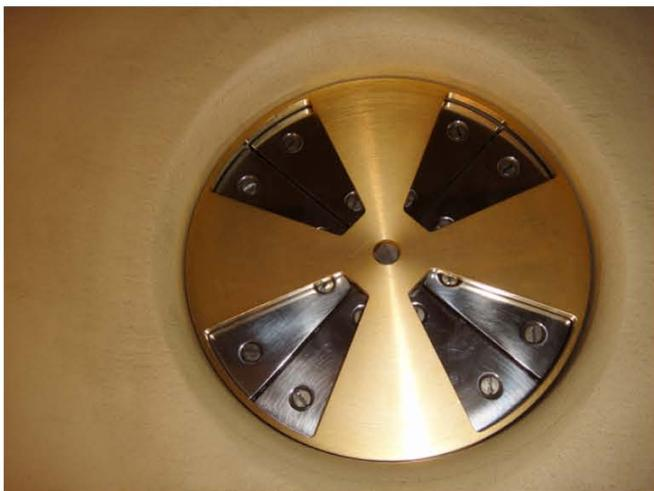
写真5 加速器タンク内で見える GVM 装置の構造
