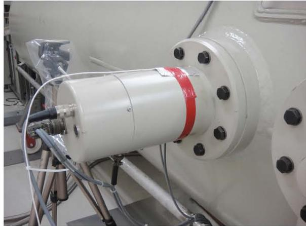
写真2 加速器タンクの外から見た GVM 装置
