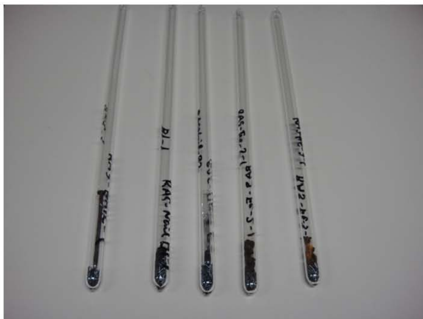
写真 1 石英管に鉄サビ試料を酸化銅と共に真空封管
